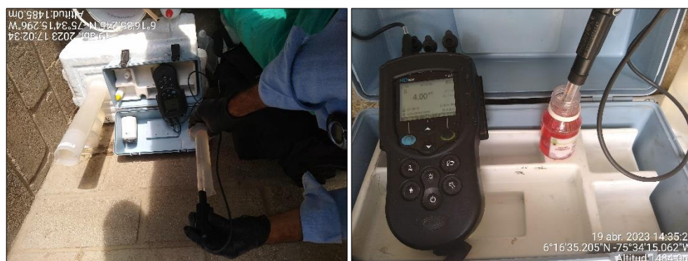
Foto 6. Medición pH y Temperatura in situ de la IA009-2023 VERTIMIENTO ARND
