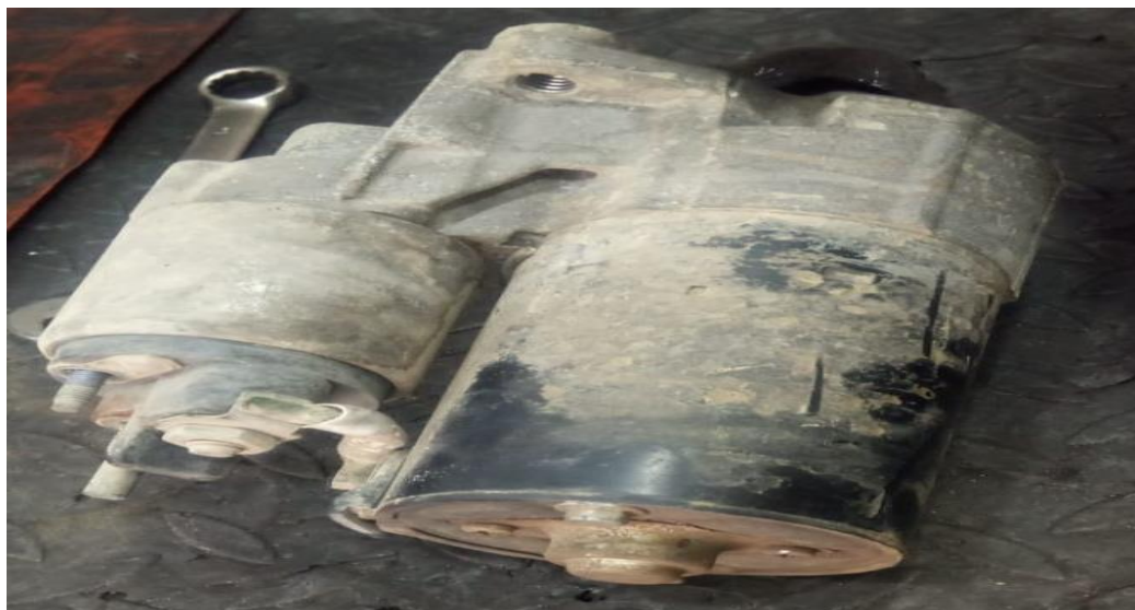
F1. arranque desmonatado para mantenimiento.
