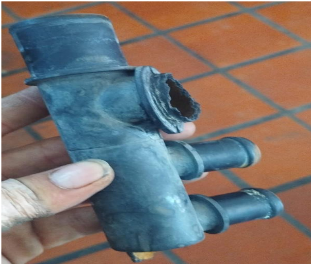
F1. Tubo original partido y cristalizado por fatiga del material
