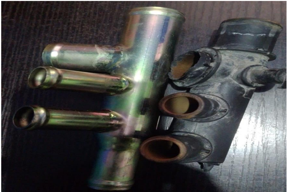
F2. Tubo de reemplazo lado izquierdo- tubo roto lado derecho
