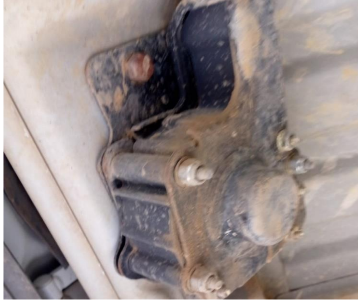
F1. Pito de reversa en mal estado.
