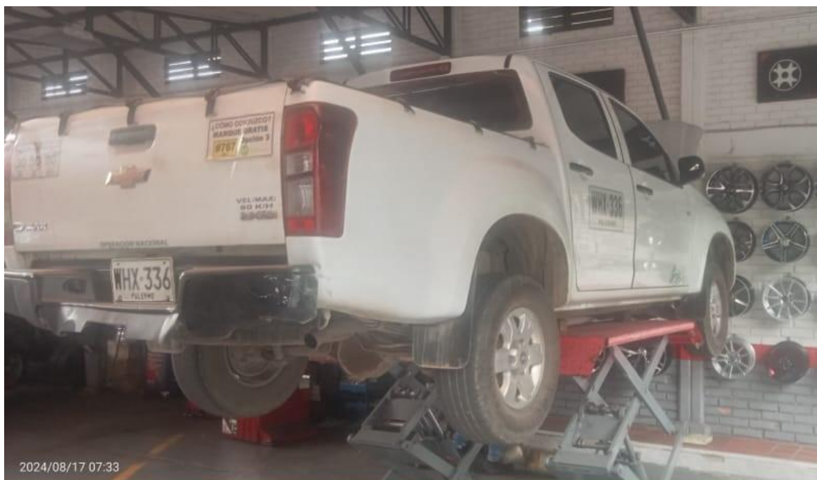
f1 Vehículo en plataforma o elevador para proceder con el cambio de aceite.
