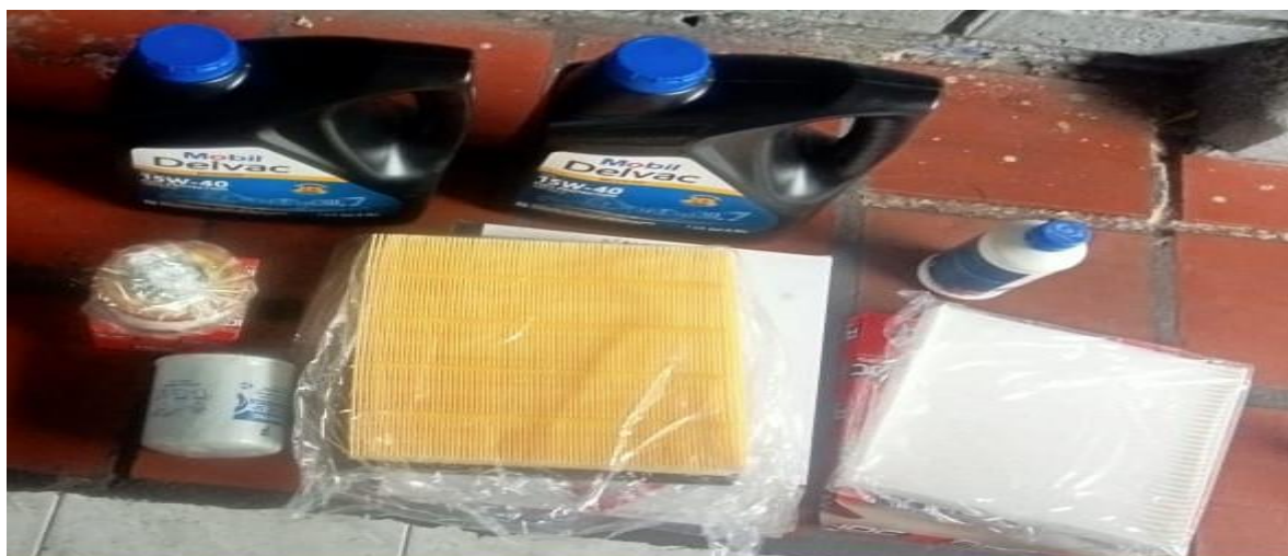
f2 Componentes y repuestos, para proceder con el cambio de aceite y filtros
